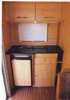
Kombüse: Kompakte Küche im Heck mit Dreiflammherd und 89-l-Kühlschrank
