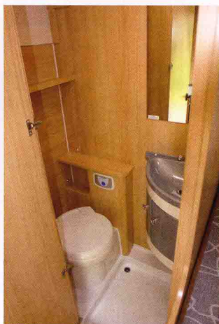
Sanitär: Funktionales Bad mit Schwenk-WC, Duschtasse und Eckwaschbecken
